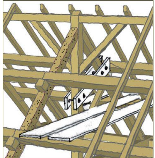
2. On reconstitue le triangle indéformable de la ferme à l'aide d'une pièce moisée reliant le poinçon à l'autre arbalétrier.
