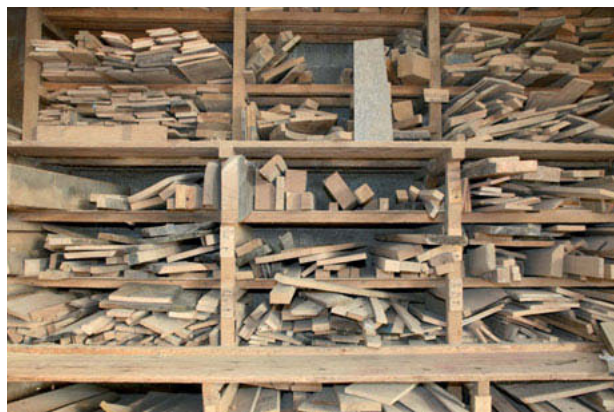
Dans un atelier de charpentier, tous les bois sont rangés par essences pour faciliter leur utilisation.
