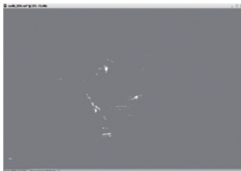
Utilisation de la fonction Double seuil (les trois canaux RVB sont au-delà du seuil).
