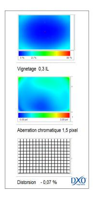
Entre 24 et 35 mm, un transtandard offre le cadrage... standard des  $24 \times 36$  avec une vision naturelle. La qualité optique est très bonne à 24 mm avec un vignetage peu visible (0,3 IL), une aberration chromatique discrète (1,5 pixel) et une distorsion quasiment invisible avec une déformation simple à corriger de -0,07 % en coussinet.
