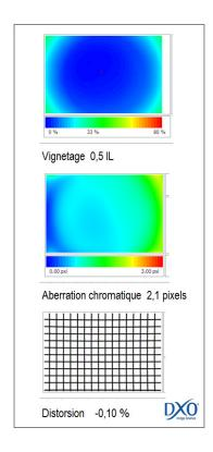
À 200 mm, le vignetage reste modeste (0,5 IL) et la distorsion est toujours très bien contenue avec -0,10 %, ce qui ne se remarque quasiment jamais. L'aberration chromatique augmente en revanche avec 2,1 pixels à pleine ouverture et 1,6 pixel à f/8 et f/11, la carte indique l'existence d'un léger décentrage de l'optique.
