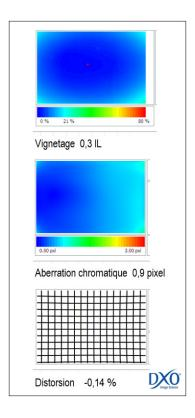
À 35 mm, le vignetage (0,3 IL) et l'aberration chromatique (0,9 pixel) diminuent, tandis que la distorsion s'inverse en coussinet, mais d'une façon très modérée (-0,14 %) qui se remarquera peu en pratique du fait de sa faible intensité.
