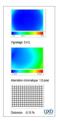
À 135 mm, le vignetage reste très faible (0,4 IL) mais l'aberration chromatique augmente, la carte révélant un léger décentrage sur notre exemplaire de test : elle atteint 1,8 pixel à pleine ouverture et ne diminue qu'à 1,6 pixel à f/16. La distorsion inversée en coussinet reste de très bon niveau et se corrige facilement si besoin (-0,15 %).
