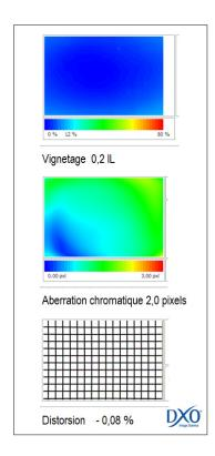
À 55 mm, le vignetage est quasiment invisible (0,2 IL) et la distorsion en coussinet reste peu visible et très facile à corriger (-0,08 %). En revanche, l'aberration chromatique se diffuse plus sur l'image, même si son niveau, un peu trop élevé avec 2 pixels, n'est pas encore alarmant.
