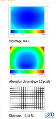
À 18 mm, le vignetage est bien maîtrisé (0,4 IL), mais l'aberration chromatique est nettement trop élevée, quoiqu'heureusement cantonnée dans les coins supérieurs de l'image, ce qui dénote un décentrage de notre exemplaire de test. La distorsion en barillet reste modérée avec 0,48 % et sa correction sera aisée le cas échéant.
